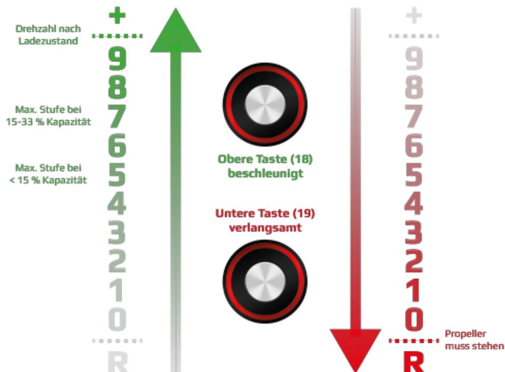
Wenn Sie die obere Piezo-Taste drücken (Abb. 2, Pos. 18) wird die nächsthöhere Fahrstufe gewählt. Durch Drücken der unteren Piezo-Taste (Abb. 2, Pos. 19) wird die nächstniedrigere Fahrstufe gewählt. Mit jedem Tastendruck erfolgt der Wechsel um eine Fahrstufe.
